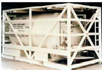
Результатом 30-летнего опыта производства оборудования для перевозки сжиженных технических газов явилось новое поколение 20' и 40' контейнеров для транспортировки сжиженных технических газов и СПГ. Использование самых современных технологий и применение высококачественных материалов позволили достичь оптимальных конструктивных решений и максимальных объемов транспортируемого продукта при минимальной собственной массе.
